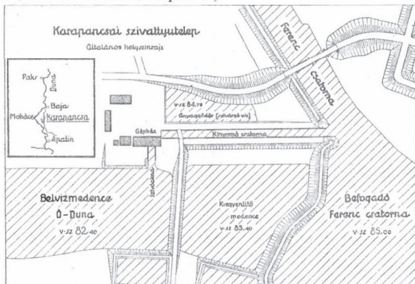
1. ábra. A karapancsai szivattyútelep általános helyszínrajza (Ihrig, 1934)
